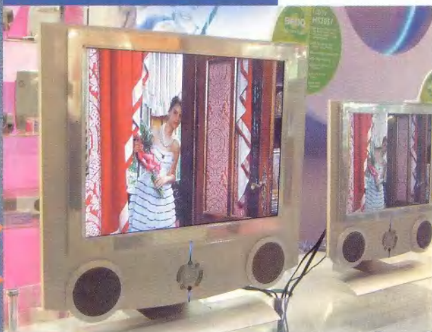
Беспроводной ЖК-телевизор с HS2081 фирмы Benq с 20-дюймовым экраном и яркостью 800 кд/м 2
